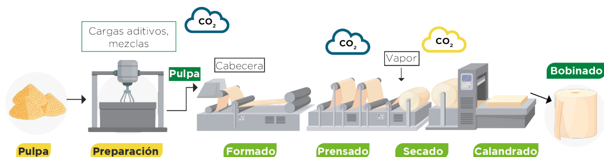
Figura 8. Proceso de producción de papel
